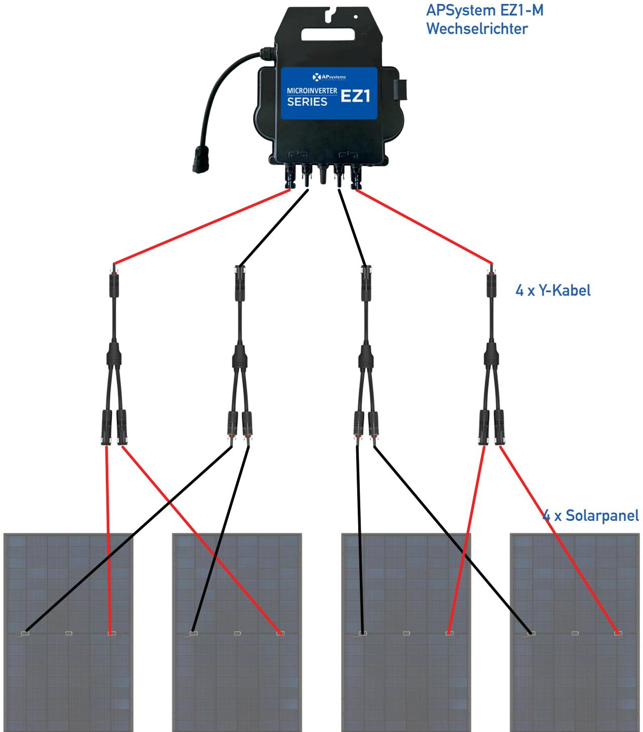
Bitte beachten: Eine falsche Verkabelung kann zum defekt des Wechselrichters führen. Bitte prüfe vor dem Einschalten die korrekte Verpolung.
